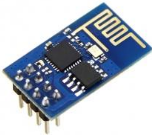
Рис. 5. Мініатюрний Wi-Fi модуль на базі мікросхеми ESP8266 з вбудованим стеком протокола TCP/IP та керуванням AT-командами
