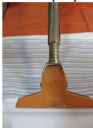
Рис 3. - Процес вимірювання зусилля розшарування ручним динамометром
