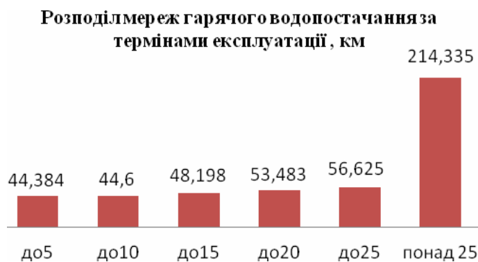
Рис. 3. Розподіл мереж гарячого водопостачання за термінами експлуатації
