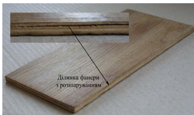
Рис. 4 Зразок фанери с дефектом (розшарування)
