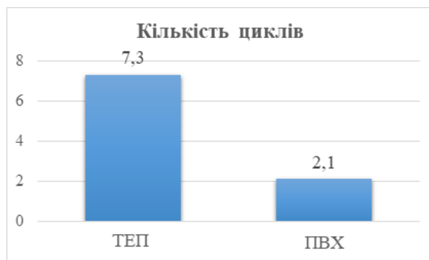
Рис. 3. Кількість циклів згину перед втомним руйнуванням
