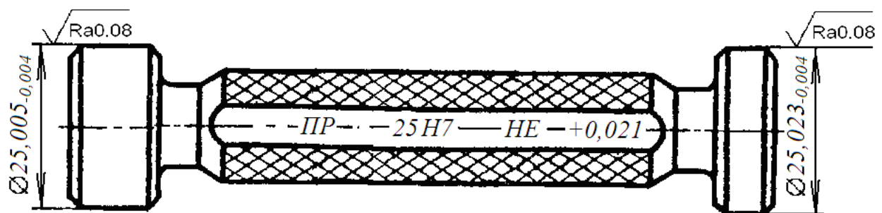
Рис. 7.3. Калібр-пробка для контролю отвору Ø25 H7
