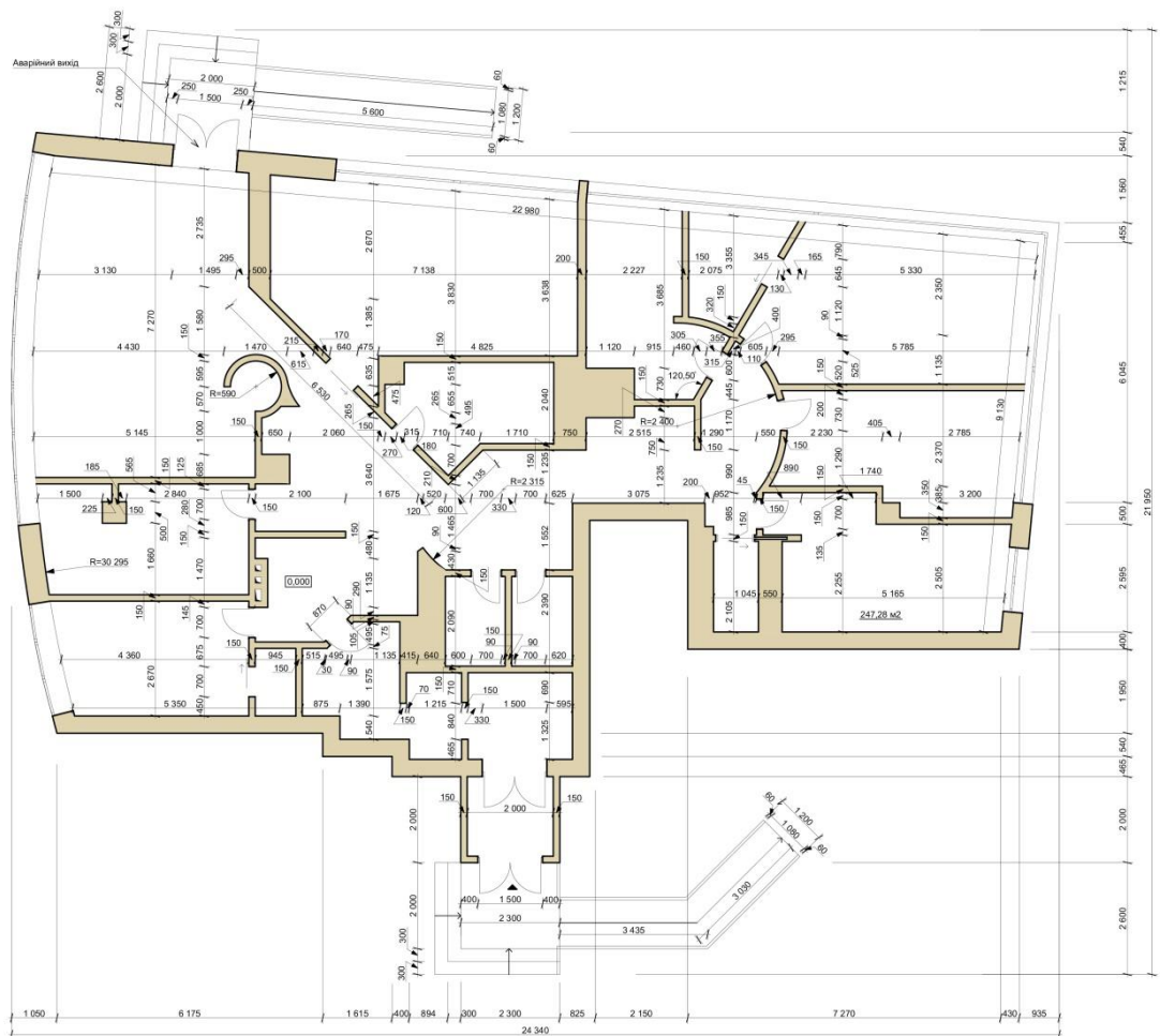
Рис. 2.2 Обмірний план приміщення.
