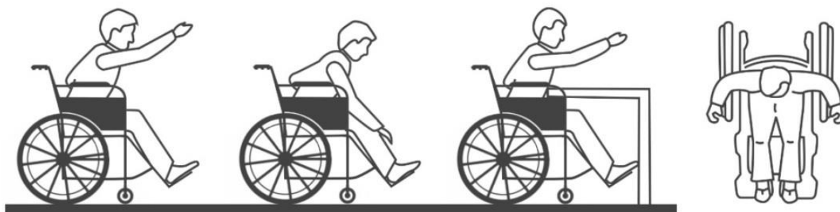
Рис.2.1. Типові рухи людини при переміщенні за допомогою інвалідного крісла-коляски механічного типу
