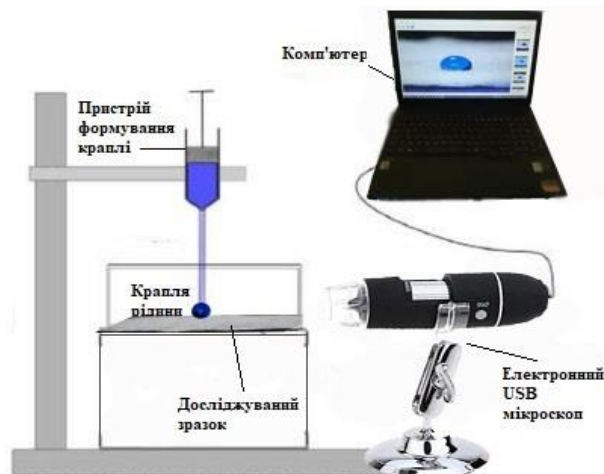
Рис. 2.14. Схема визначення крайового кута змочування
