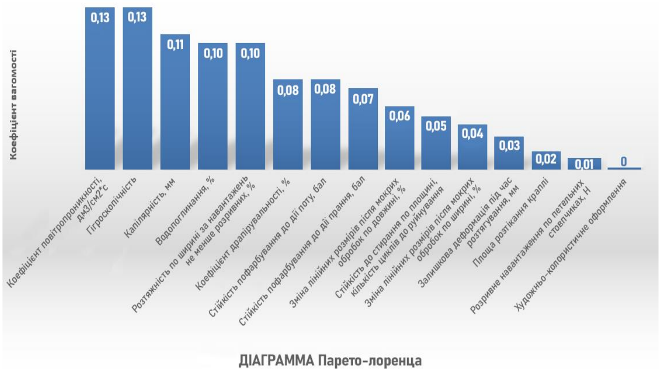
Рисунок 2.12. Коефіцієнти вагомості показників якості трикотажних полотен для спортивного костюму
