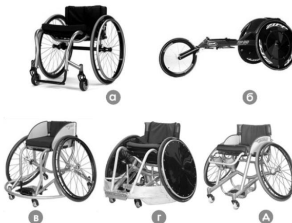
Рис.1.7. – Конструкції інвалідних візків для занять спортом: а - звичайний візок, б- гоночний, в - для баскетболу, г - для регбі, д - для тенісу
