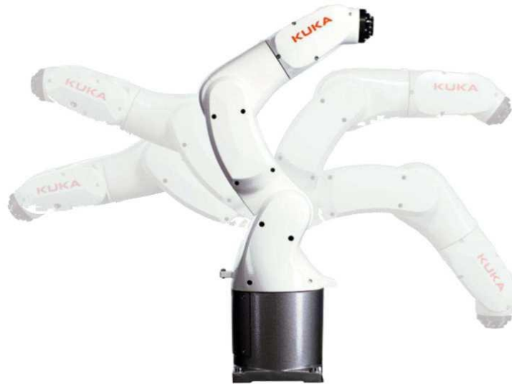
Рис. 1.6. Робот-маніпулятор Kuka KR3 AGILUS
