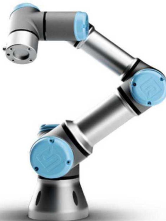
Рис. 1.8. Робот-маніпулятор Universal Robot UR3
