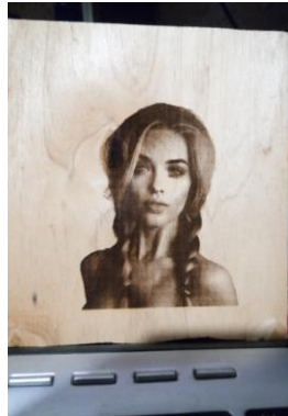
Рисунок 3.17 – Тестове гравіювання на дереві
