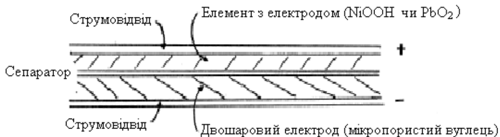
Рис. 2. Схема гібридного суперконденсатора
