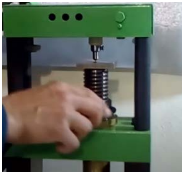
Рисунок 3. Піджим поверхні зразка до індентора
