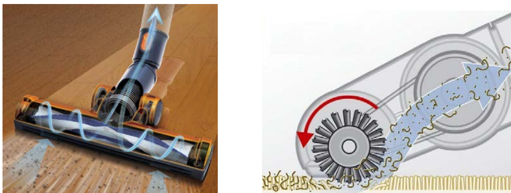
Рисунок 1 – Схема руху потоку повітря усередині турбощітки
