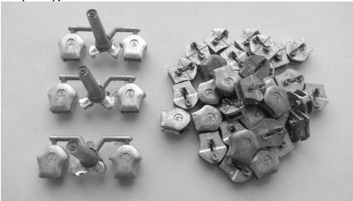
Рис. 8.8. Відливки замка «блискавка» до початку обробки, а також відокремлені деталі по завершенню обробки в машині, робоча ємкість якої виконує складний просторовий рух
