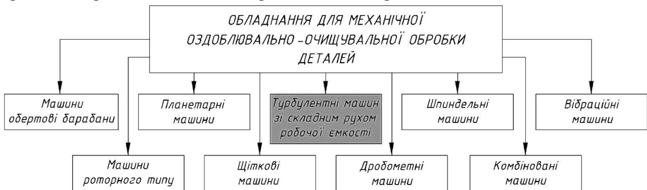
Рис. 1.2. Класифікація обладнання за конструкцією, для оздоблювально-зачищувальних процесів обробки деталей
