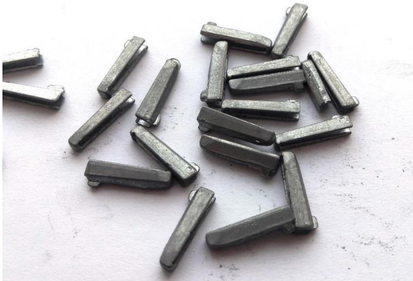
Рис. 8.13. Фіксатори замка «блискавка», які пройшли повний цикл обробки в машині зі складним просторовим рухом ємкості
