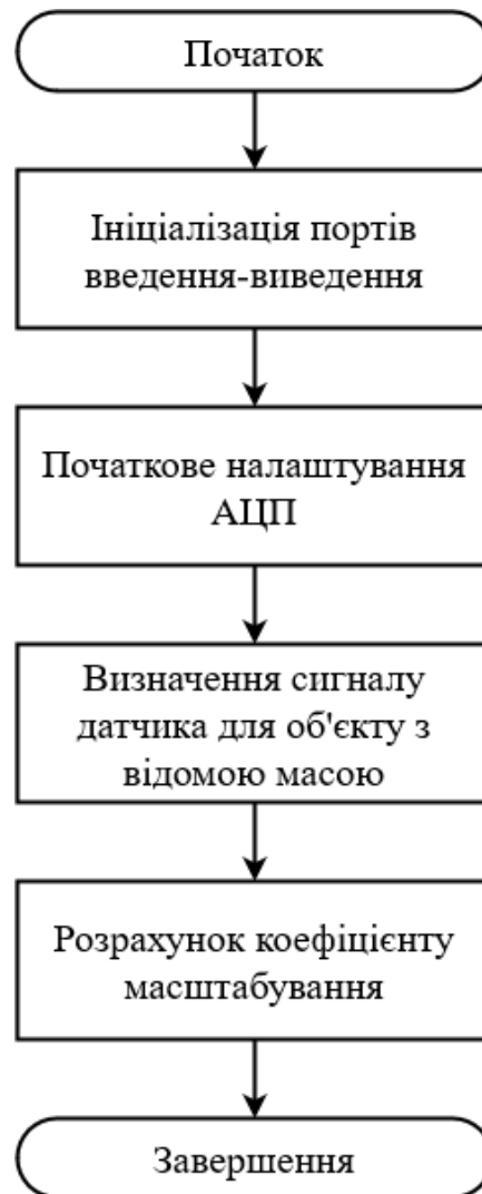
Рис. 3.4. Схема алгоритму калібрування датчика маси.
