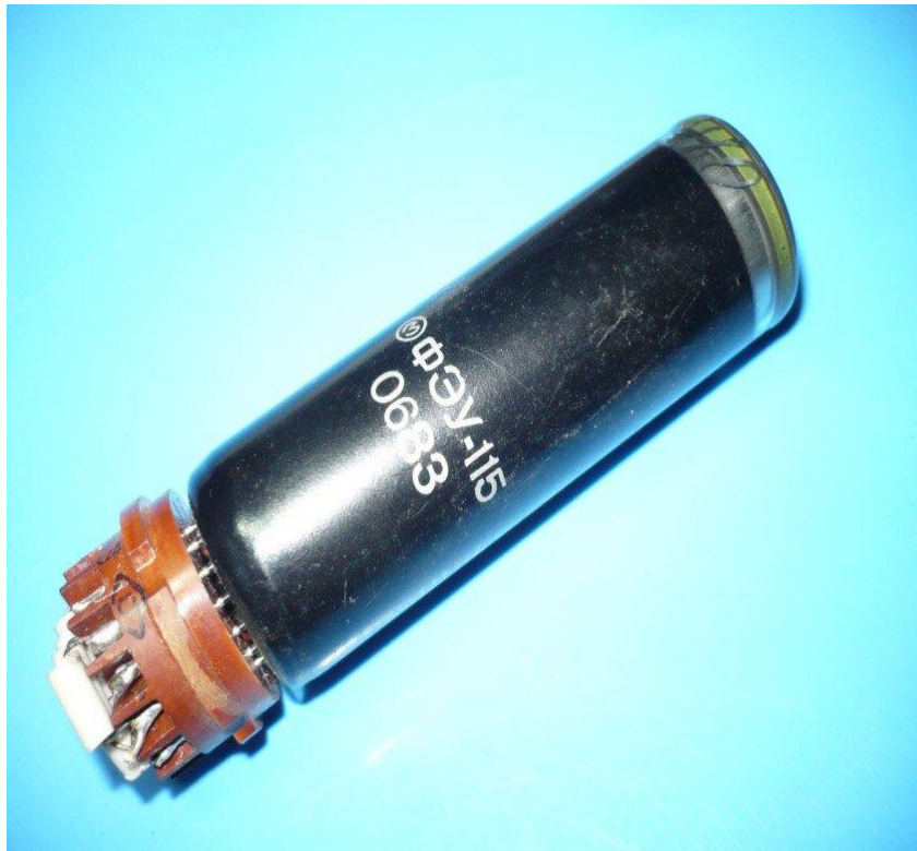
Рис. 2.1 – Фотоелектронний помножувач ФЭУ-115 для вимірювання інтенсивності бактеріальної люмінесценції
