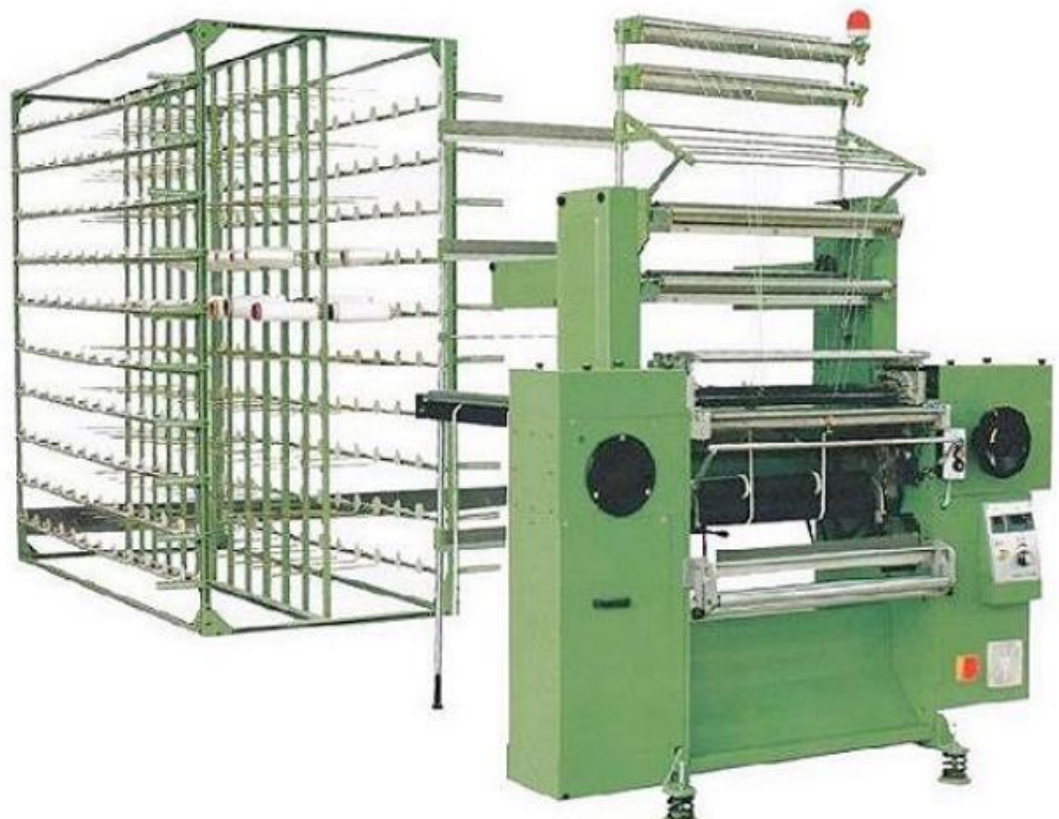
Рис 2.2. Зовнішній вигляд основов'язальної тамбурної машини
