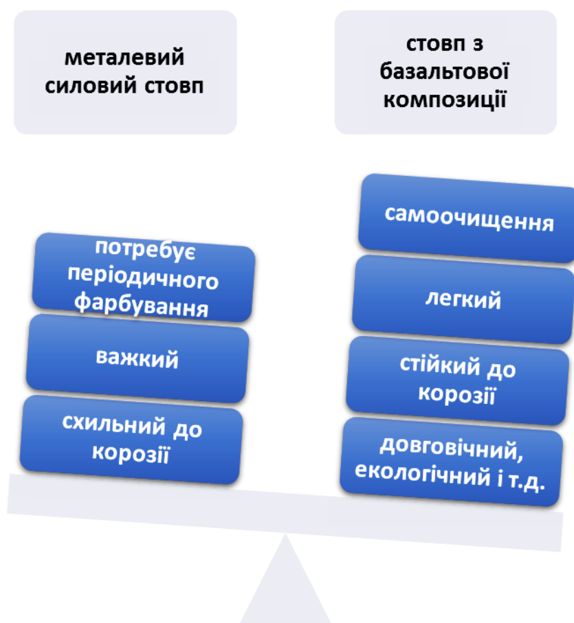
Рис. 2.6 Порівняння властивостей стовпа, що виготовлений з металу з тим, що виготовлені з базальтового композиту.
