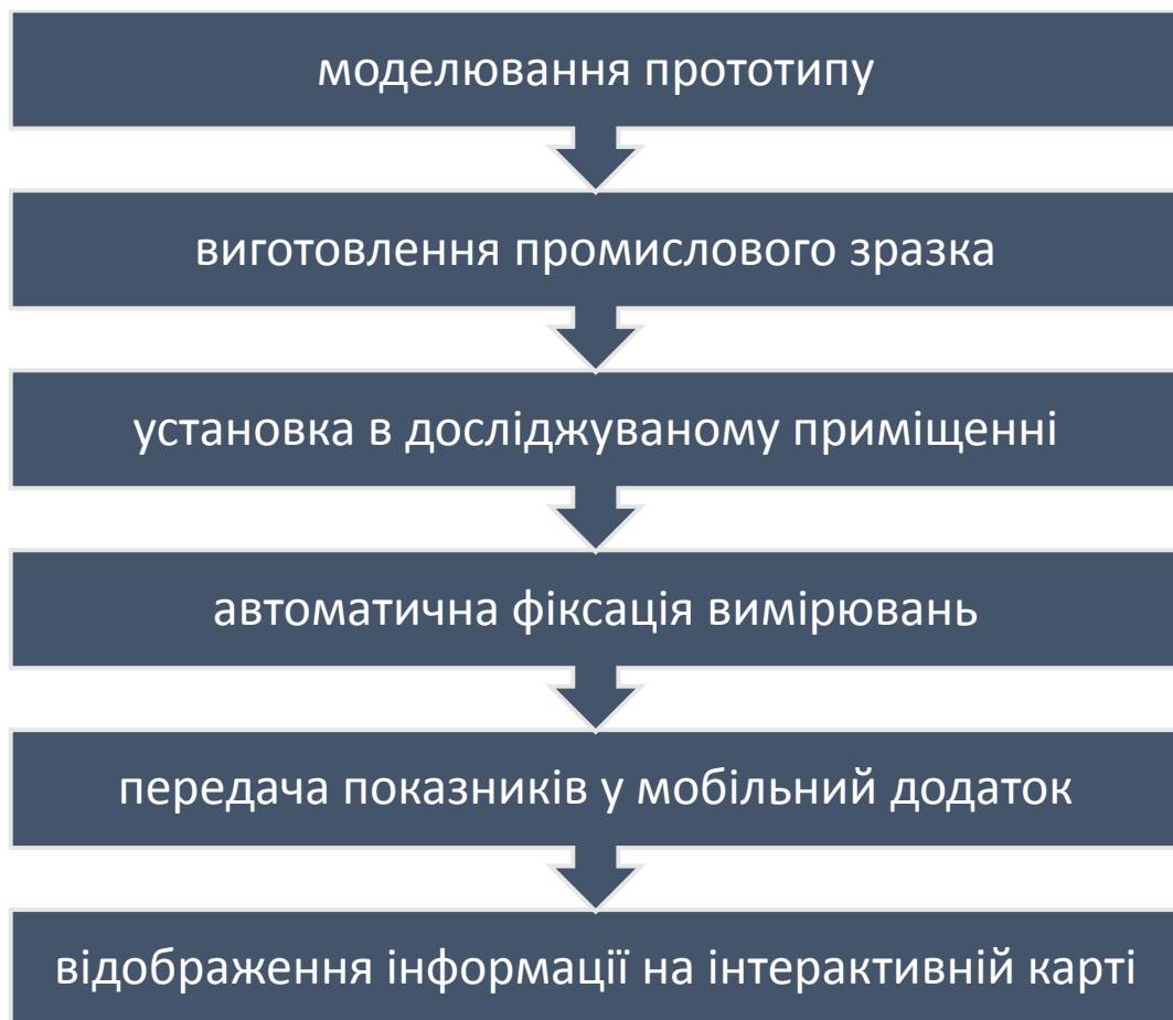
Рис. 3.9 Система моніторингу ефективності використання ВЕС з ротором Оніпко
