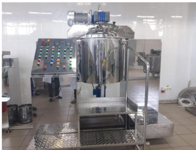
Рисунок 2.7 – Загальний вигляд хімічного реактору STS Group
