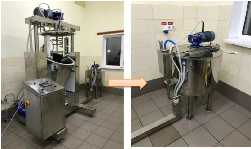
Рисунок 2. 3 – Загальний вигляд хімічного реактору із електричним нагріванням STS Group
