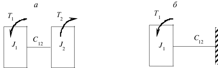
Рис. 1. Двомасова динамічна модель приводу круглов'язальної машини типу КО:
