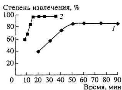
Рис. 2. Зависимость степени извлечения золота от времени плавки. 1 - без воздействия УЗ, 2 - при воздействии УЗ.
