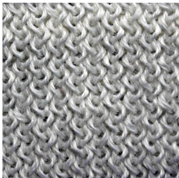
Рис.2. Графічний запис (а) та структура (б) подвійного кулірного пресового трикотажу з несиметричними накидами
