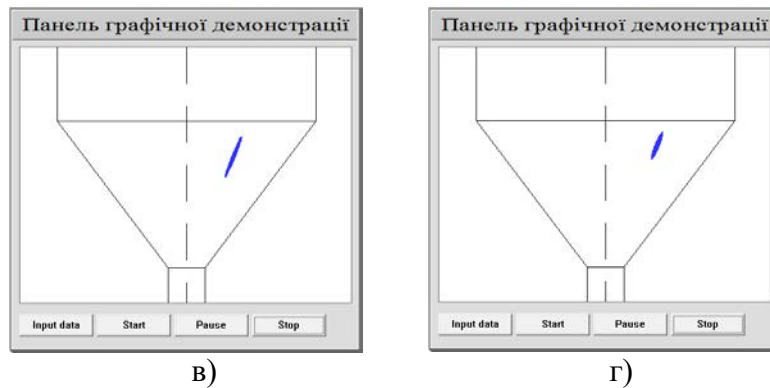
Рис.2. Комп'ютерна модель впливу співвідношення в'язкостей полімеру дисперсної фази і матриці на деформацію краплі: K = 1.0 (а); K = 2.5 (б); K = 6.7 (в); K = 10.0 (г)
