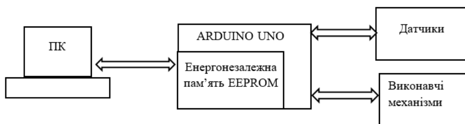
Рисунок 1 - Схема програмно-технічного комплексу контролю та управління доступом до ресурсів мікропроцесорної системи
