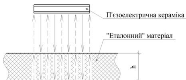
Рис. 1. Тракт відбиття пакету акустичних коливань у загальному виді
